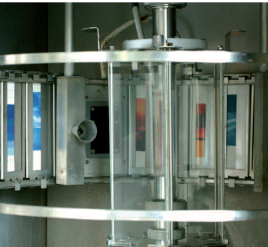
Résistance au vieillissement: mise en place des échantillons. © Centexbel
