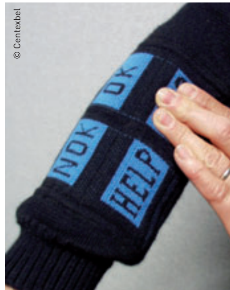
Pullover communicant avec intégration d'un système électronique.
