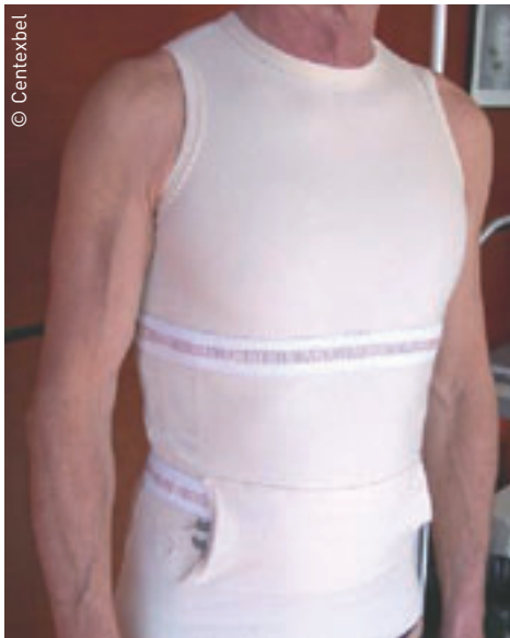
Sous-vêtement avec capteurs textiles.
